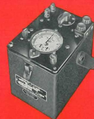
Fig. 4 - Contatore campione portatile
