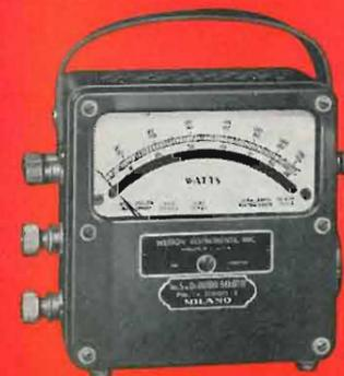
Fig. 3 - Wattmetro portatile
